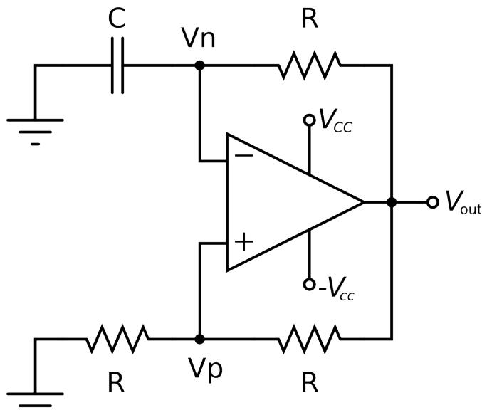
**Figura 1:** Oscilador de Relaxamento baseado num amp-op ideal e duas malhas de realimentação, um com condensador.
