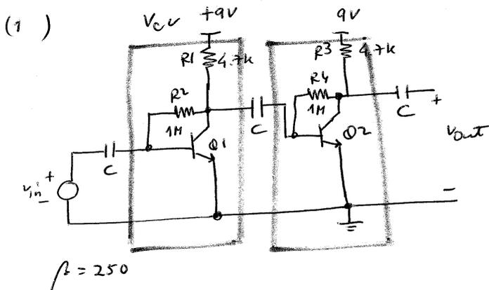
(1a) Ponto de funcionamento dos transistores
