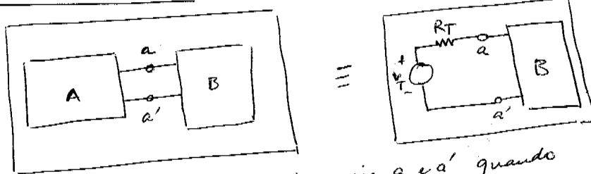
$R_T$  — resistência vista dos terminais  $a$  e  $a'$  quando se retiram do circuito todas as fontes independentes
