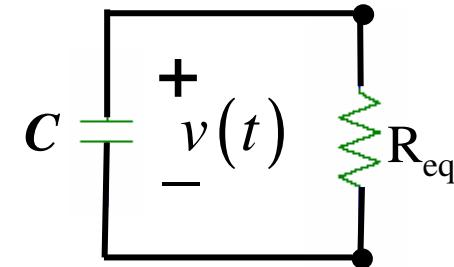
$$R_{eq} = R_1 // R_3 + R_2$$
