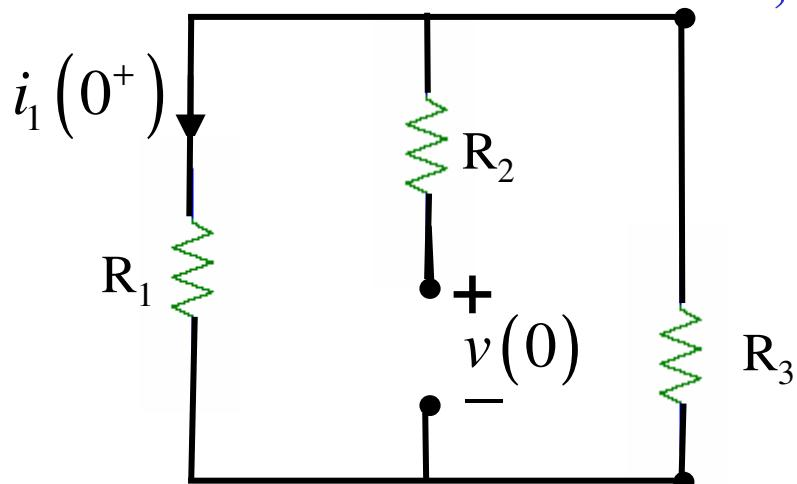
$$i_1(0^+) = \frac{R_1 R_3}{R_1 R_2 + R_2 R_3 + R_1 R_3} V_0$$
